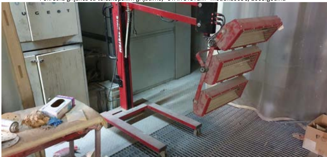
Pokretna grijalica sa teleskopskim grijačima, "STAR SYSTEM" model:1003C, 2003.godina
