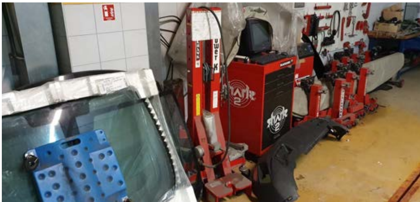
Uređaj za precizno mjerenje kod limarskih radova, "BLACK HAWK" model:SHARK 2
