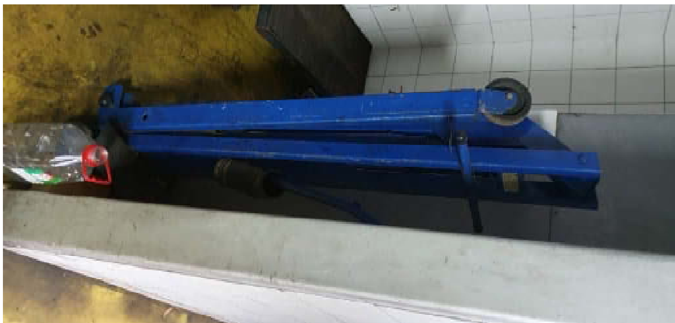
Hidraulična ručna dizalica, "AC HYDRAULIC A/S" model:WJN5, 2003.g
