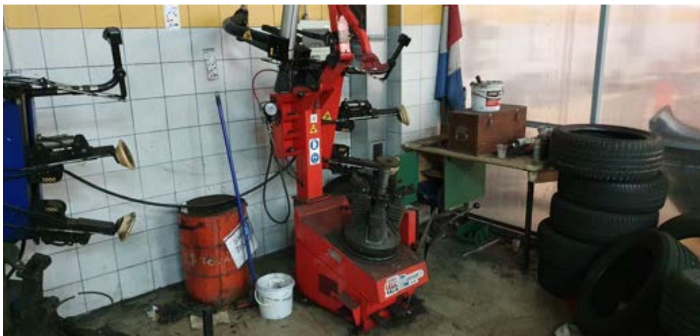
Stroj za montiranje guma, "REMA TIP TOP" model:PLUS 94, 2013.godina
