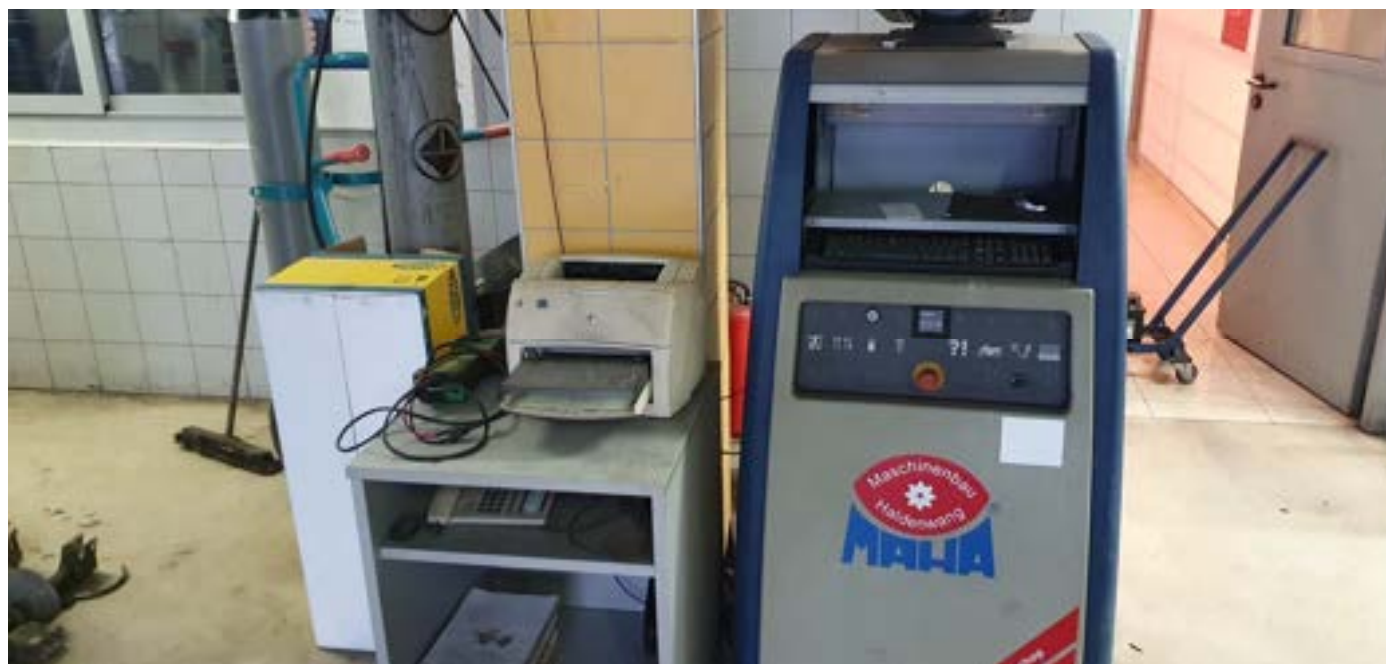
Uređaj sa valjcima za testiranje kočnica "MAHA" model:WGB05, Lg0205, max 3500kg
