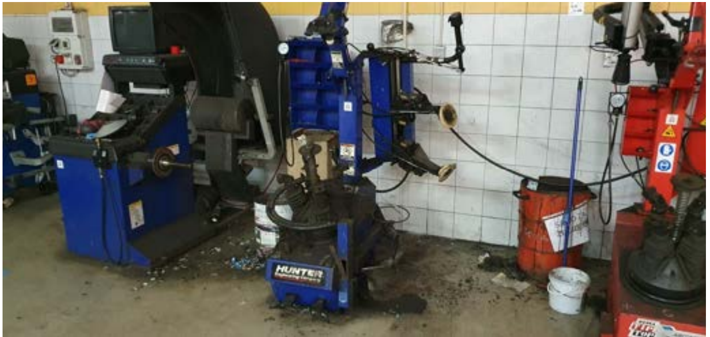
Stroj za montiranje guma, "HUNTER" model: BUTLER 1004K000, 2005.godina
